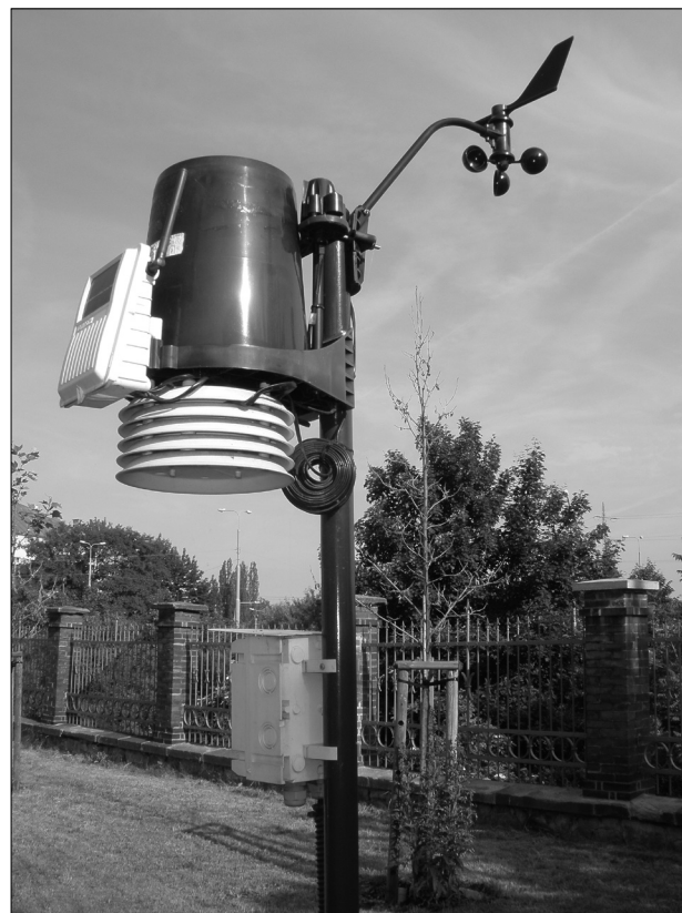
Obr. 2. Školní meteorologická stanice Vantage Pro2™ Plzeň-Veleslavínova; zdroj: foto autor
